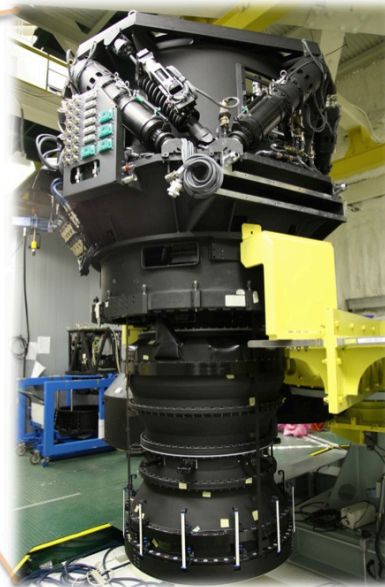
Hyper Suprime-Cam (高さ約3m、重さ約3トン)
