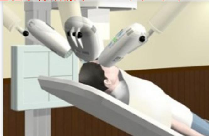
重粒子線治療の革新的診断装置として技術移転中のASTRO-Hの軟ガンマ線検出器用Si/CdTe半導体コンプトンカメラ (JAXA/群馬大学共同記者発表から)
