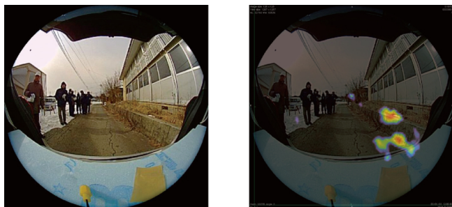
図6 左は魚眼レンズを付けたカメラ, 右は超広角コンプトンカメラで撮影した画像。 ^{134}\text{Cs} , ^{137}\text{Cs} から直接放出される 605, 662, 796, 802 keV から再構成されたガンマ線の強度(フラックス)分布, 分布の中心に向かうほど強度が高い. サーベイメータの測定では中心の場所で地上 1cm の強度が約 30 \mu\text{Sv/h} , またカメラの付近における環境バックグラウンドは約 3 \mu\text{Sv/h} であった.
